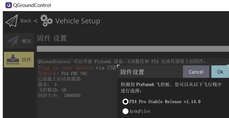
就能自动开始下载固件，从下载固件的链接中，可以获取编译命令。例如：下图所示的页面中，我们从中获取到的编译命令为 `px4_fm-v6c_default`
